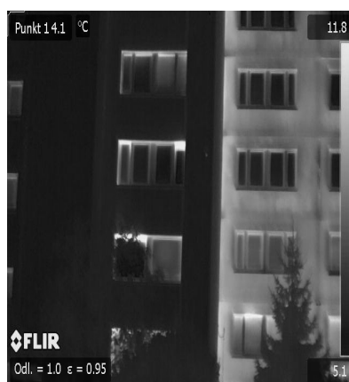
Rys. 7. Zdjęcie wykonane kamerą termowizyjną i aparatem fotograficznym. Rozkład temperatur na ścianach budynku wielopłytkowego nieocieplonych i docieplonych dodatkową warstwą styropianu
