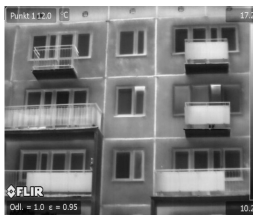
Rys. 8. Zdjęcie wykonane kamerą termowizyjną i aparatem fotograficznym. Rozkład temperatur na ścianach budynku wielopłytkowego z widocznymi łączeniami między płytami
