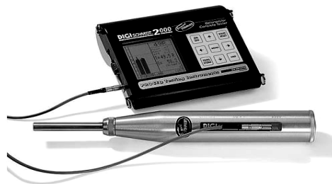
Rys. 2. Młotek Schmidta stosowany do badań sklerometrycznych betonu
