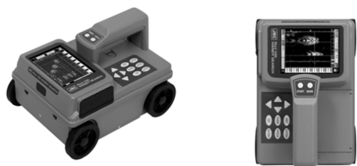
Rys. 4. Georadar stosowany do lokalizacji zbrojenia w żelbecie oraz do wykrywania pustek i nieciągłości struktury betonu
